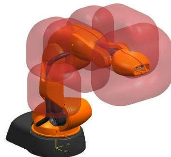
**Abbildung 1: Robotersystem KR 5 SI mit den Messbereichen der kapazitiven Näherungssensoren**
